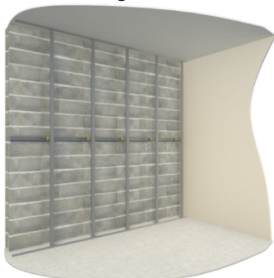
Figure 3.1 - Pose de l'ossature métallique Optima 2 (Lisses, Fourrures, Rallonges et appuis Optima 2 )
