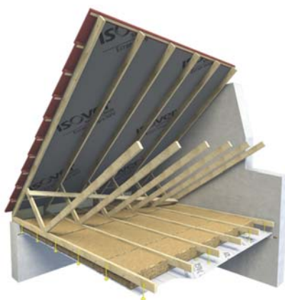
Figure 2.3 : Pose de la membrane pare-vapeur (ex : Vario ® Xtra) à l'aide des suspentes Integra 2
