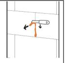
panneaux isolants peuvent être comblés à l'aide de mousse expansive FM110 (classée B1). Couper les résidus et excès de mousse après durcissement à l'aide d'un outil adapté.
