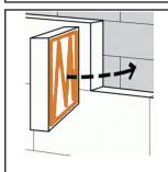
Attendre que la légère post expansion soit terminée. Monter alors le panneau isolant avec une légère pression. Délai d'utilisation: 10 minutes.
