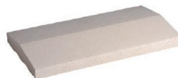
Les Chaperons de Mur À Deux Pentes ont un design, à double pente, qui permet de garder les murs propres et secs avec une grande facilité. Ils disposent d'une goutte d'eau comme toute la gamme de Chaperons SAS et des rainures dans la partie inférieure qui permet une meilleure fixation avec le mûret. Nos Chaperons de Mur sont fabriqués en deux types de finition: vibro-pressé "Dry-Cast" ou béton coulé "Wet-Cast".
